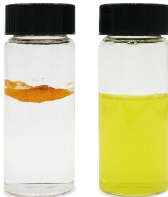
Das Strahlschichtverfahren von Glatt bietet gegenüber der herkömmlichen Sprühtrocknung klare Vorteile und wird zur industriellen Herstellung der staubfreien Curcushine-Mikrokapseln eingesetzt. Rechts: Der reine Curcumin-Extrakt ist in Wasser nahezu unlöslich (links), während das optimierte Produkt die gewünschte Löslichkeit zeigt (rechts).
