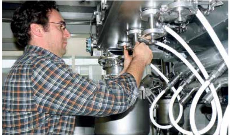
beispielsweise wird der Ablauf Sprühen, Aufziehen (Benetzen) und Filmverfestigung so lange wiederholt, bis die rieselfähigen Granulate ihre Zielgröße erreicht haben und aus dem Prozess ausgeschleust werden.
