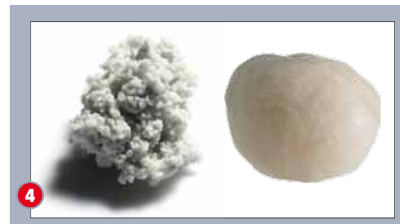
4: Produktstrukturen im Vergleich (links: Agglomerat / rechts: Sprühgranulat)
