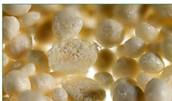
Werden Enzyme nach einer Vorbehandlung mit einem Feststoff besprüht, bildet sich eine Coating-schicht, welche die Aktivstoffe vor Feuchtigkeit, Sauerstoff und vorzeitiger Freisetzung schützt.
