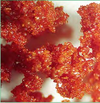
In der Wirbelschicht verbinden sich sehr kleine Partikel, z.B. Pulver, mit Binderflüssigkeiten zu Agglomeraten mit verbesserten oder neuen Eigenschaften.
