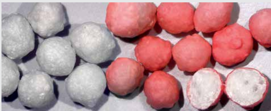
Bild 4 Die Düngerkörner können mittels Coating mit einem farbigen Branding oder mit einem pH-Wert gesteuerten Freisetzungprofil ausgestattet werden.
