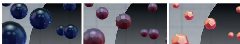
**Bild 6** Für chemische und mineralogische Reaktionen werden die Partikel extrem schnell gebildet, thermisch behandelt und abgekühlt; die schematische Darstellung zeigt die Umwandlung der eingesprühten Rohstofflösung über die kristallisierenden Strukturen bis hin zum kalzinierten Partikel
