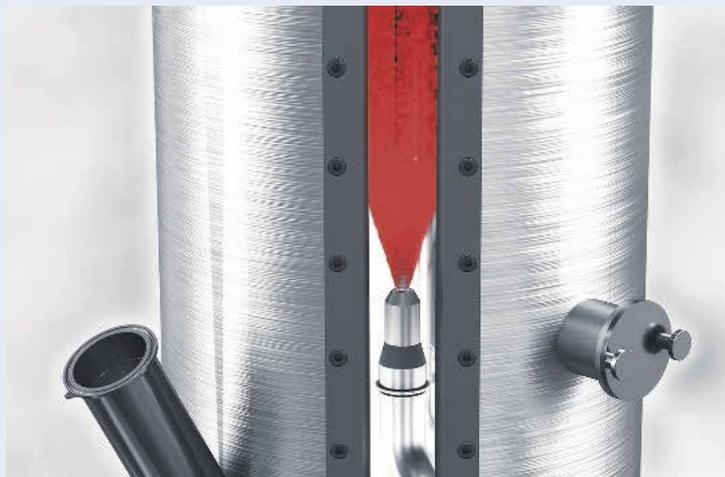
*Die Pulversynthese erfolgt im kontrolliert pulsierenden Heißgasstrom*
