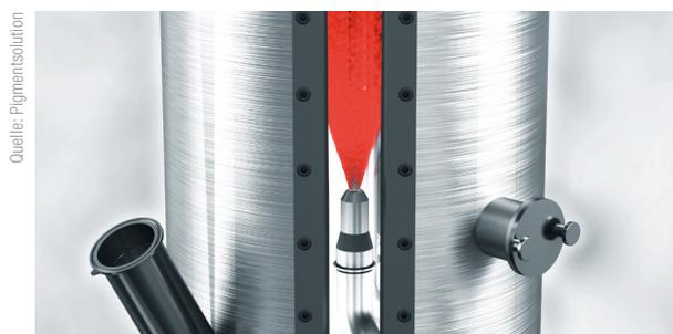
**Abb. 3 //** Im Synthesereaktor pulsiert ausschließlich der Gasstrom kontrolliert in der speziell konstruierten Brennkammer. Zur Partikelherstellung werden feine Tröpfchen einer Rohstofflösung in den Gasstrom eingesprüht – aus ihnen bilden sich die Partikel.
