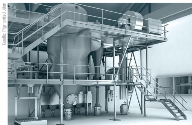
**Abb. 8 //** Versuchs- und Produktionsanlage ProAPP zur Herstellung von Hochleistungspulvern wie Mattierungsmitteln.
